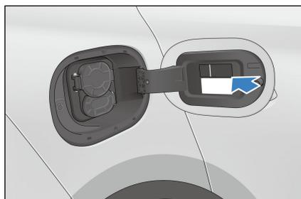
La etiqueta indicadora de carga está pegada en el lado interior de la bisagra del puerto de carga.
