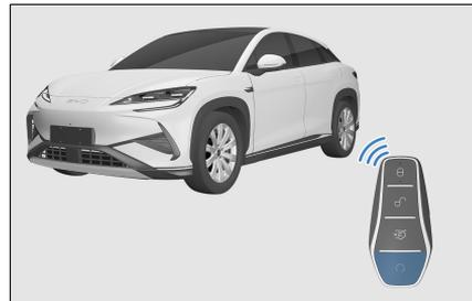
3. Para apagar el vehículo, pulse durante 2 segundos el botón de arranque/parada remoto de la llave inteligente. El vehículo se apaga y los intermitentes parpadean dos veces.
