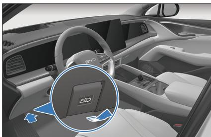
2. Levante el capó a una altura adecuada. Terminará de abrirse del todo de forma automática.
