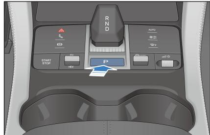
La transmisión solo puede cambiarse a D/R con el encendido conectado.
