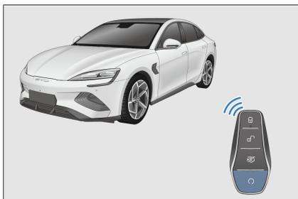
3. Mantenga pulsado el botón de arranque/parada remoto de la llave inteligente electrónica durante dos segundos. Se para y se apaga el vehículo y los intermitentes parpadean dos veces.
