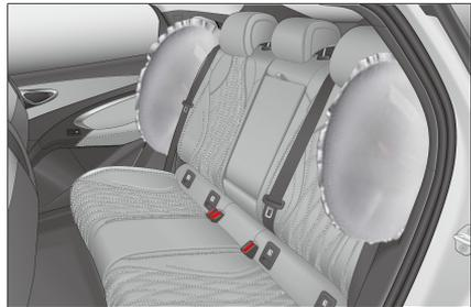
**Proceso de activación de los airbags laterales de los asientos**
