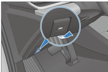
2. Para abrir el capó: Eleve la campana a la altura adecuada y, a continuación, se elevará automáticamente al estado abierto.
